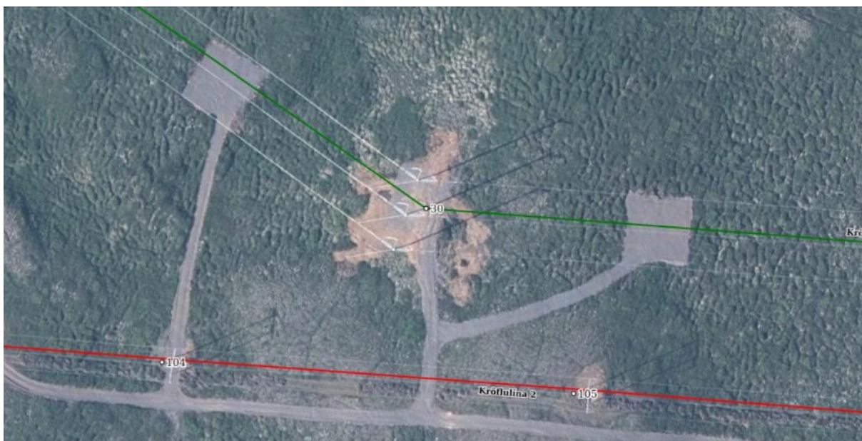
Mynd 6.9 Loftmynd af kortasjá sýnir strengingarplön sitt hvoru megin við hornmastur í Kröflulínu 3.
