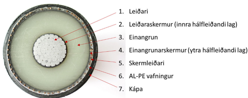
MYND 3.4 Dæmigerður 220 kV álstrengur með mikla flutningsgetu [24].
