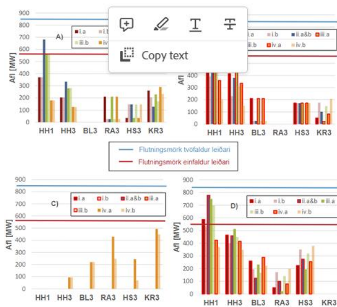
MYND 5-3: FLÆÐI UM LÍNURNAR HOLTAVÖRÐUHEIDARLÍNA 1 (HH1), HOLTAVÖRÐUHEIDARLÍNA 3 (HH3), BLÖNDULÍNU 3 (BL3), RANGÁRVALLALÍNU 3 (RA3), HÓLASANDSLÍNU 3 (HS3) OG KRÖFLULÍNU 3 (KR3) FYRIR ÖLL TILFELLI ÞEGAR ÞAÐ ER TRUFUN Á: A) BLÖNDULÍNU 3, B) RANGÁRVALLALÍNU 3, C) HOLTAVÖRÐUHEIDARLÍNU 1 OG D) KRÖFLULÍNU 3.
